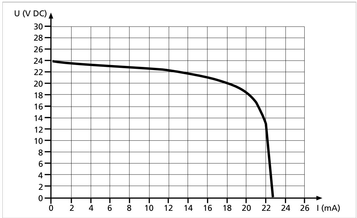
Abb. 30: Ausgangskennlinienfeld STO Out Status
